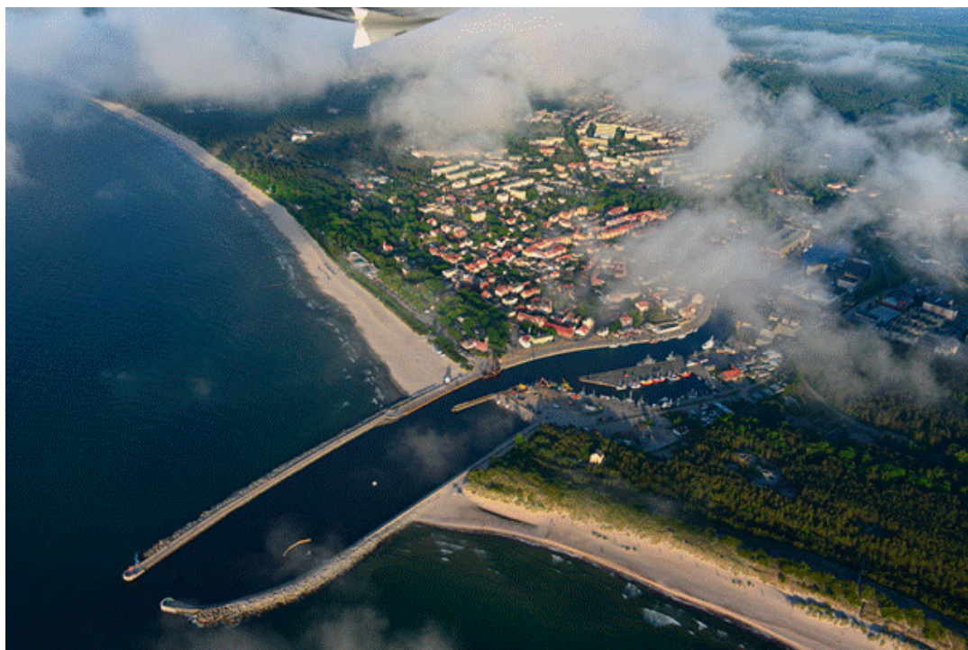
Fot. 19. Falochrony w Łebie. Zatrzymują piasek po stronie zachodniej, a po wschodniej brakuje go. Od 1993 r. prawie co roku, plaża jest refulowana, na potrzeby turystyki i do ochrony pałacyku wybudowanego na wydmie w 1906 r.
