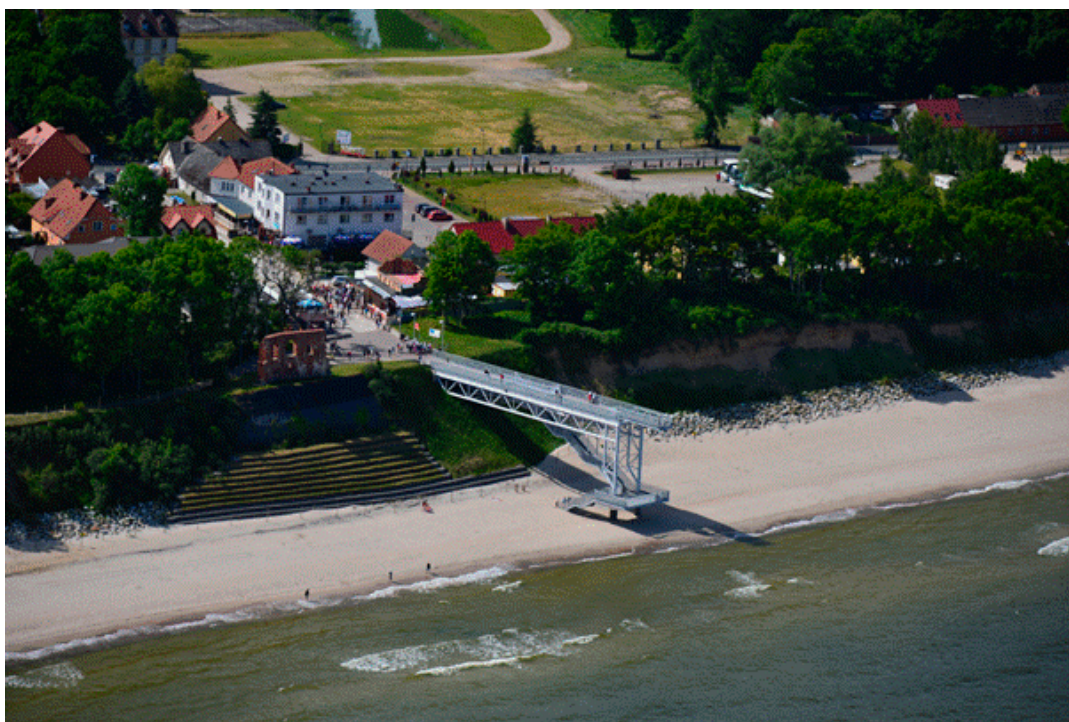
Fot. 22. Opaska gabionowa na ścianie klifu – kosztowna ochrona ruiny kościoła w Trzemesznie. Po bokach nowa opaska kamienna, ciągnąca się na długości 3 km. W planach jest jej przedłużenie o kolejne 2 km. Spektakularny nowy pomost służy od 2009 r. turystom. Dawne schody, zniszczyło morze
